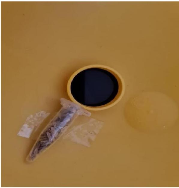
La provetta deve essere posizionata con l'apertura poggiata sul bordo interno del foro della coppetta. Il tappo deve essere chiuso ma forato, in maniera tale da non permettere fuoriuscite di materiale. Il tutto deve essere fissato con nastro adesivo trasparente.
